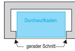
Der für den Einbau benötigte Steinzuschnitt (gerader Schnitt / kein Anschlag) kann einfach bauseits durchgeführt werden. Auf Wunsch auch werkseitig, Lieferzeit 1 Woche, Aufpreis für die Zuschnitte an 3 Steinen € 69,60
