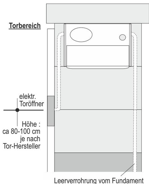
Bei Verwendung eines elektr. Toröffners benötigen Sie eine weitere Leerverrohrung vom Briefkasten zum Toröffnerbereich, welcher sich meist in einer Höhe von ca. 80 cm befindet. Die notwendige Bohrung erfolgt entweder genau in der Fuge, oder mittig im Stein.
