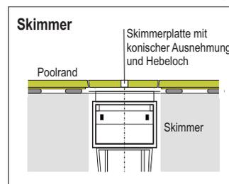
Mit modernsten Maschinen wird ein Deckel geschnitten, der durch seine konische Ausführung mit Hebeloch für eine optimale Bedienung sorgt.
