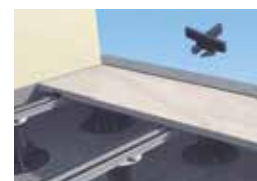
Platten mit Abstandhalter verlegen
