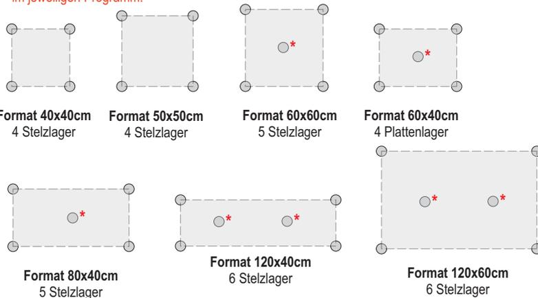
\* = bei den als Mittelstütze dienenden Stelzlagern sind die Fugenkreuze an den Sollbruchstellen abzubrechen
